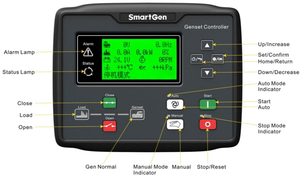
**Fig.1 - HGM6110N/ HGM6110NC/ HGM6110CAN Front Panel Indication**
